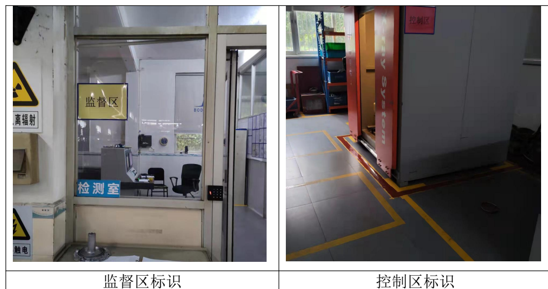
图 8-1 探伤室辐射工作场所分区示意图
